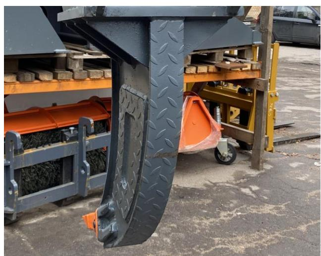
Элементы клыка выполнены из конструкционной низколегированной стали 09Г2С, устойчивой к низким температурам и хорошо удерживающей сварной шов. Благодаря применению данного материала изделие в достаточной мере защищено от ударной нагрузки и имеет хороший запас прочности.
