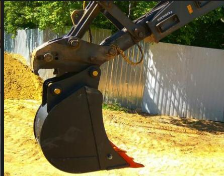
Оборудование устанавливается на обратную рукоять экскаватора-погрузчика при помощи пальцевого соединения либо через промежуточное быстросъемное устройство (клик-каплер). В зависимости от марки экскаватора-погрузчика расстояние между проушинами, вынос и диаметр пальцев могут отличаться. В ряде случаев отличается сама конструкция ковшевых проушин. Присоединительные размеры согласовываются в ходе формирования заказа на производство.
