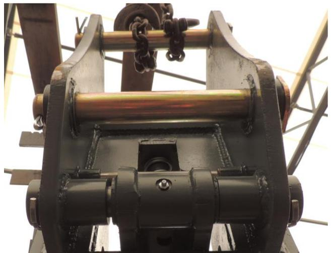
Быстростъем выполнен из конструкционной низколегированной стали 09Г2С, устойчивой к низким температурам и хорошо удерживающей сварной шов. Благодаря применению данного материала изделие в достаточной мере защищено от ударной нагрузки и имеет хороший запас прочности.
