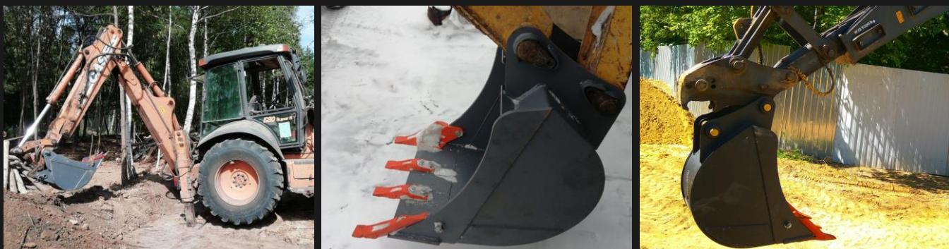
Оборудование устанавливается на обратную рукоять экскаватора-погрузчика при помощи пальцевого соединения либо через промежуточное быстросъемное устройство (квик-каплер). В зависимости от марки экскаватора-погрузчика расстояние и между проушинами, вынос и диаметр пальцев могут отличаться. В ряде случаев отличается сама конструкция ковшевых проушин. Присоединительные размеры согласовываются в ходе формирования заказа на производство.
