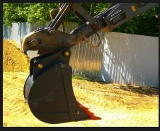
Оборудование устанавливается на обратную рукоять экскаватора-погрузчика при помощи пальцевого соединения либо через промежуточное быстросъемное устройство (квик-каплер). В зависимости от марки экскаватора-погрузчика расстояние и между проушинами, вынос и диаметр пальцев могут отличаться. В ряде случаев отличается сама конструкция ковшевых проушин. Присоединительные размеры согласовываются в ходе формирования заказа на производство.
