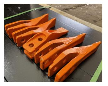
Ковшевые зубья устанавливаются на штатную режущую кромку ковша на болтовом соединении. Являются расходными элементами на которые приходится основная нагрузка. Предназначены для проведения общеземельных работ. Количество и тип зубьев зависит от ширины и модели изделия.
