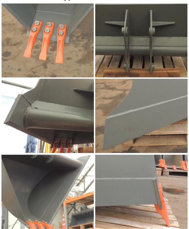
Элементы ковша выполнены из конструкционной низколегированной стали 09г2с, устойчивой к низким температурам и хорошо удерживающей сварной шов. Благодаря применению данного материала изделие в достаточной мере защищено от ударной нагрузки и имеет хороший запас прочности. В основе конструкции ковша заложена толстостенная труба, выполняющая основную несущую функцию
