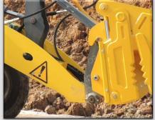
Оборудование устанавливается на стрелу погрузчика. Тип присоединения зависит от типа посадочной плиты конкретной машины. Присоединительные размеры согласовываются в ходе формирования заказа на производство.
