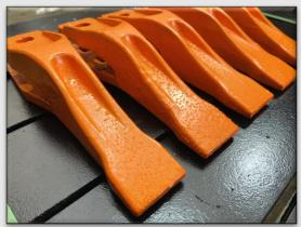
Устанавливаются на штатную режущую кромку ковша на болтовом соединении. Являются расходными элементами на которые приходится основная нагрузка. Предназначены для проведения общеземельных работ. Количество и тип зубьев зависит от ширины и модели изделия.
