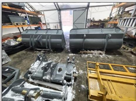
Оборудование устанавливается на стрелу погрузчика при помощи пальцевого соединения, посредством быстросъемного соединения или применяя связку быстросъем-адаптер, в зависимости от типа посадочной плиты установленной на изделии. Присоединительные размеры согласовываются в ходе формирования заказа на производство.
