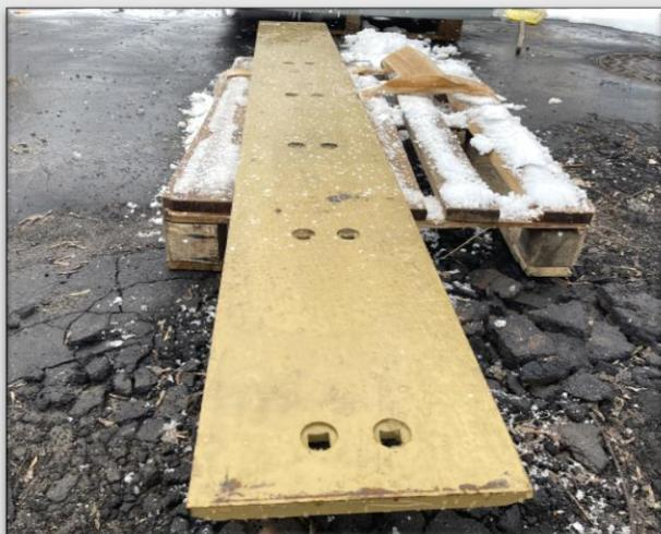
Сменная стальная кромка на болтовом соединении устанавливается в целях усиления базового штатного лезвия.
