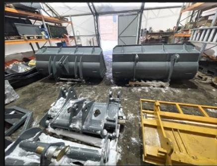
Оборудование устанавливается на стрелу погрузчика при помощи пальцевого соединения, посредством быстросъемного соединения или применяя связку быстросъем-адаптер, в зависимости от типа посадочной плиты установленной на изделии. Присоединительные размеры согласовываются в ходе формирования заказа на производство.
