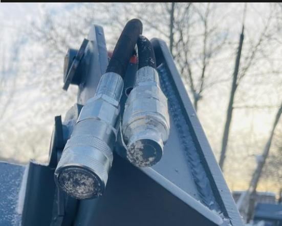
Оборудование подключается на прямую к штатному гидрораспределителю погрузчика. Подъем и опускание ковша выполняется при помощи аверсивной или реверсивной подачи гидравлического потока.
