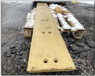
Сменная стальная кромка на болтовом соединение устанавливается в целях усиления базового штатного лезвия.
