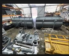
Оборудование устанавливается на стрелу погрузчика при помощи пальцевого соединения, посредством быстросъём-адаптер, в зависимости от типа посадочной плиты установленной на изделии. Присоединительные размеры согласовываются в ходе формирования заказа на производство.
