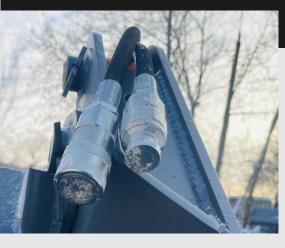
Оборудование подключается на прямую к штатному гидрораспределителю погрузчика. Подъем и опускание ковша выполняется при помощи аверсивной или реверсивной подачи гидравлического потока.
