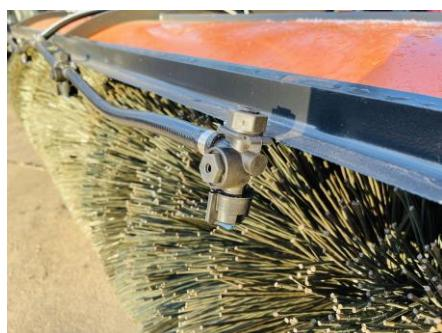
Предназначена для снижения уровня выбрасываемой грязи и пыли, основным щеточным валом. Наиболее актуальна при работе в помещениях, складских комплексах, компактных и закрытых площадках, вблизи жилых домов, детских учреждений, автостоянок, в парках и местах скопления людей.
