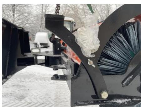
Корпус щетки оборудован фиксирующими выдвижными ножками позволяющим длительное время хранить щеточное оборудование избегая замятия щетины.
