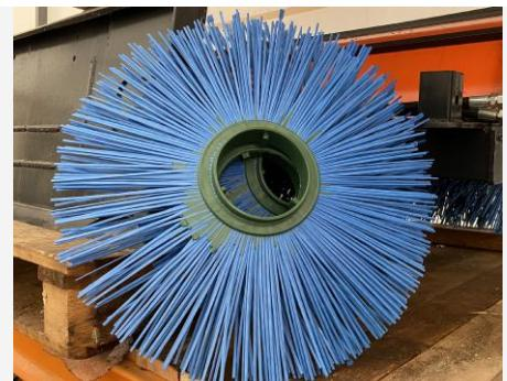
Щеточный вал оборудуется безпроставочными полипропиленовыми щеточными дисками с внутренним диаметром 180 и внешним 700 мм. Количество дисков зависит от ширины щеточного вала. Допускается использование щёточных дисков с металлическим сердечником или ворсом.
