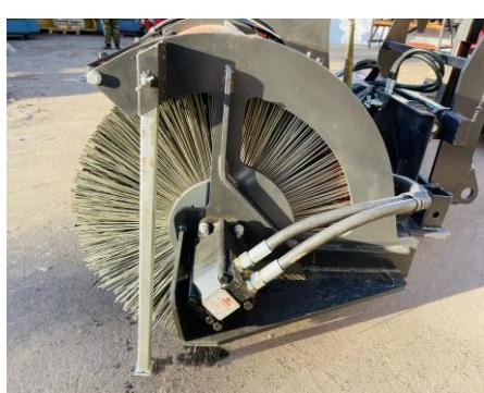
Корпус щетки оборудован фиксирующими выдвижными ножками позволяющим длительное время хранить щеточное оборудование избегая замятия щетины.
