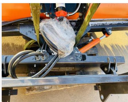
Оборудование подключается на прямую к штатному гидрораспределителю погрузчика. Вращение щеточного вала осуществляется при помощи подачи гидравлического потока.
