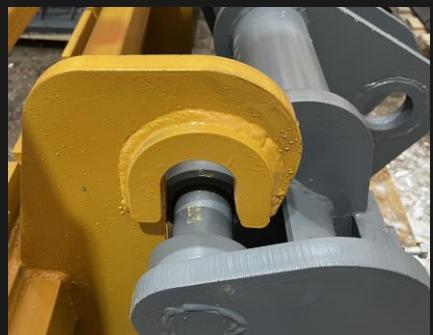
Оборудование устанавливается на стрелу погрузчика при помощи пальцевого соединения, посредством быстросъемного соединения или применяя связку быстросъем-адаптер, в зависимости от типа посадочной плиты установленной на изделии. Присоединительные размеры согласовываются в ходе формирования
